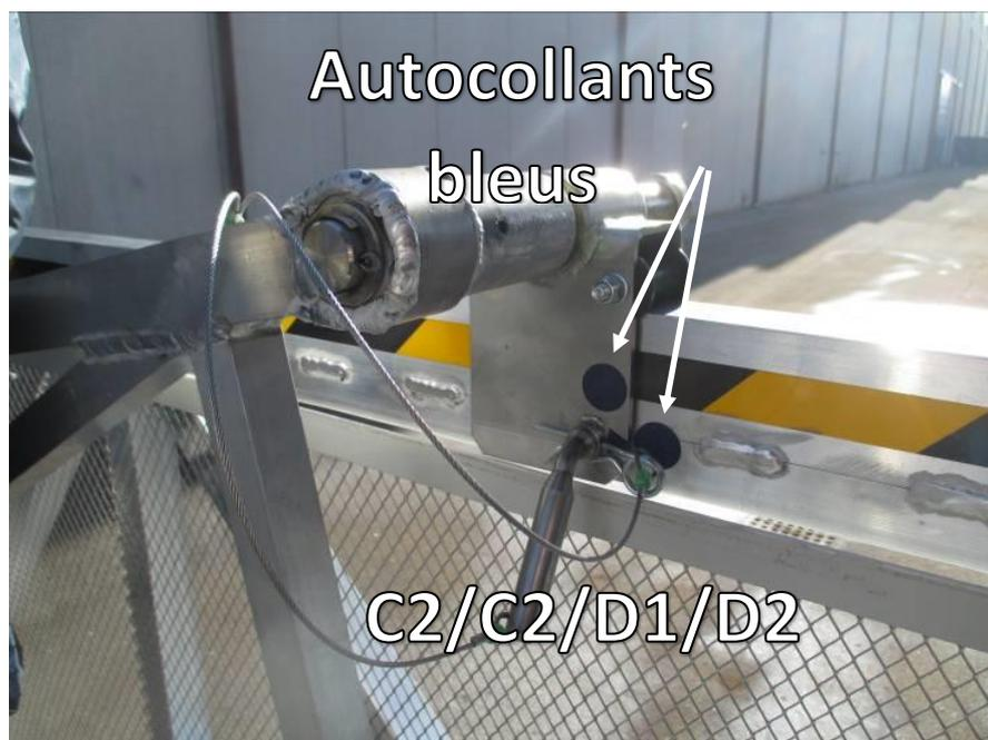
Image 7 – DÉTAIL PIVOTS C1/C2 + GOUPILLES FENDUES D1/D2 GÉNÉRIQUE
