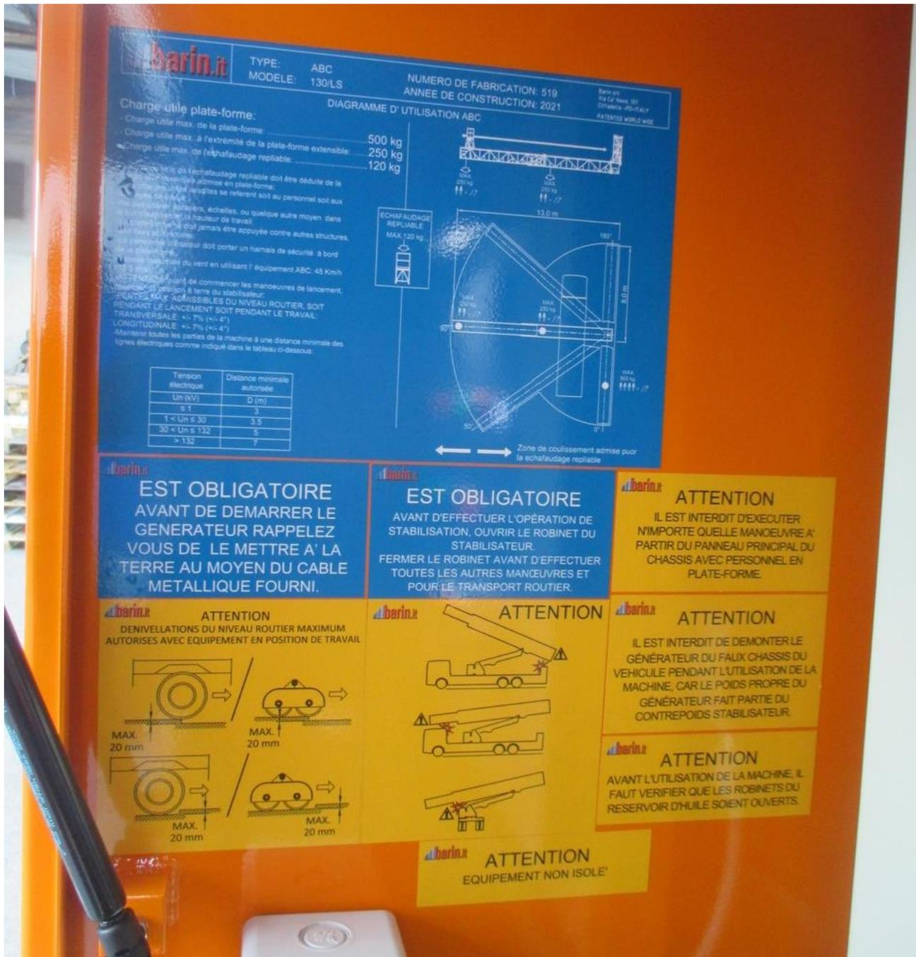
Image 5A\_Diagramme d'utilisation fixé près du poste de commande à terre
