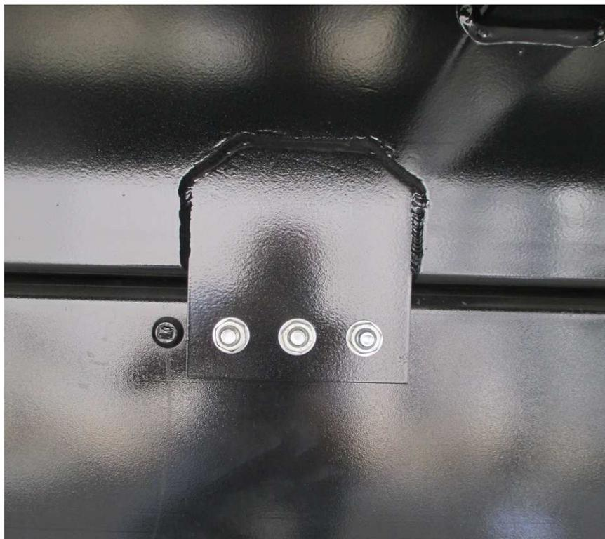
**Image 107 - Boulons de la connexion entre le faux-châssis et le châssis du porteur**
