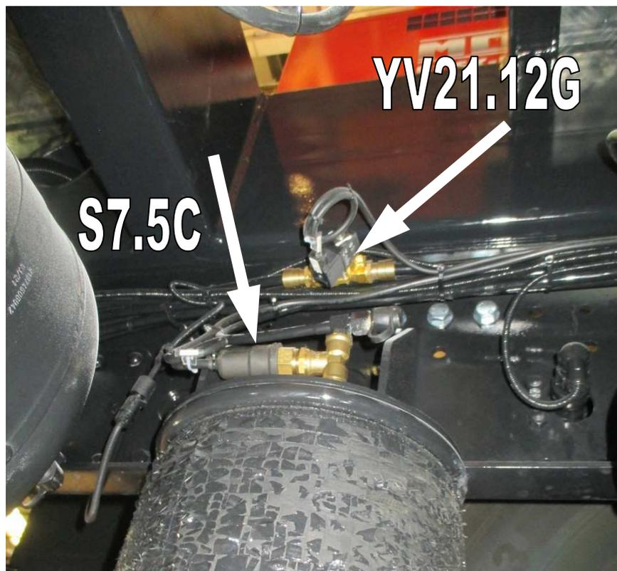
**Image 22**—pressostat essieu arrière (S7.5C) et électrovanne de sécurité suspensions (YV21.12G)
