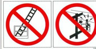
INTERDICTION D'UTILISER LA MACHINE PROCHE DES LIGNES ELECTRIQUES
